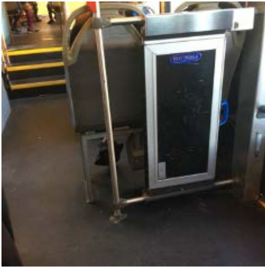
Bild 8. Spårvagn M31, med manuell ramp och trappor upp till höggolvdelen. Foto: Per Olof Larsson
