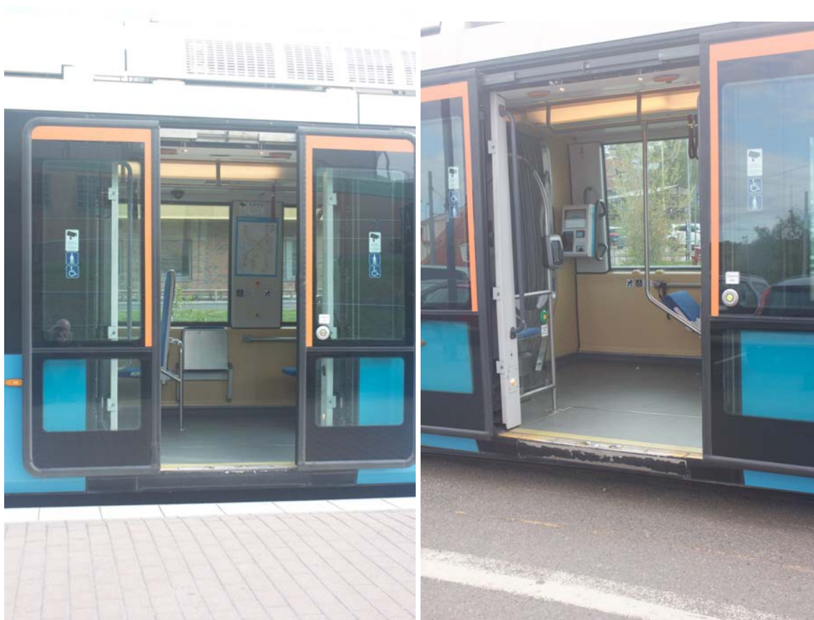
Bild 16. Litet avstånd mellan vagnens golv och perrong till vänster. Stort avstånd mellan vagnsolv och perrong till höger. Foto: Per Olof Larsson
